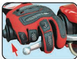
Tolak suis ke atas bagi lampu tinggi atau ke bawah bagi lampu rendah.
