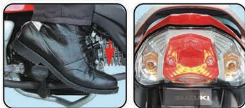
Tarik tui brek tangan dan tekan pedal brek kaki untuk memastikan lampu brek menyala.
