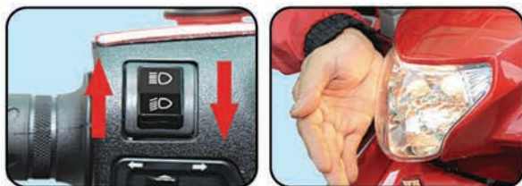
Tolak suis ke atas bagi lampu tinggi atau ke bawah bagi lampu rendah.
